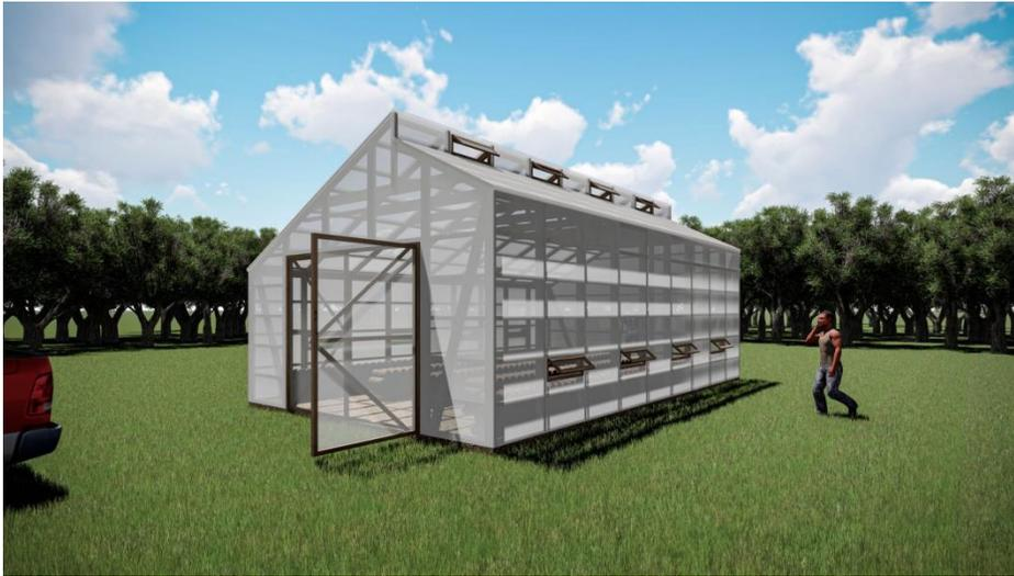
2.- Secador solar pasivo de Leña a un agua (con cálculo estructural según normativa vigente, capacidad 50 m<sup>3</sup> estéreos de leña).
